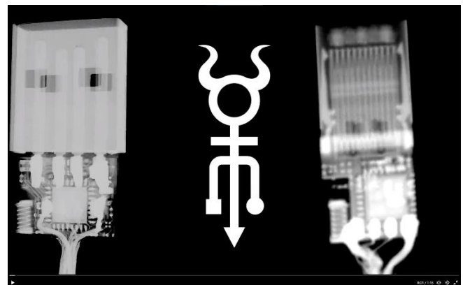
図 12 チップが埋め込まれたコネクター (O.MGアダプター製作者 Twitterの動画より)
