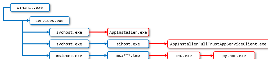
図 61 MSIX ファイル実行後のプロセスツリー(PSF なし)
